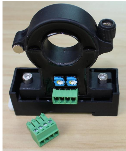
带凤凰连接件的传感器 (从底部到孔中心的距离是 54.8mm)
